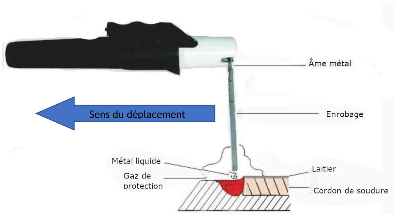
Relier la pince porte électrode et la pince de masse aux embases de puissance de l'appareil en respectant les polarités renseignées par le fabricant de l'électrode.
