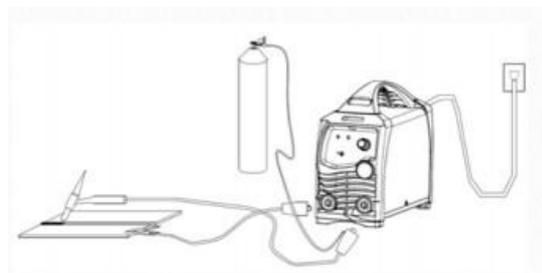
Raccorder le tuyau de gaz sur le débitmètre situé sur la bouteille de gaz et connecter l'autre extrémité à la machine. Ouvrir le gaz manuellement à la torche (robinet).
